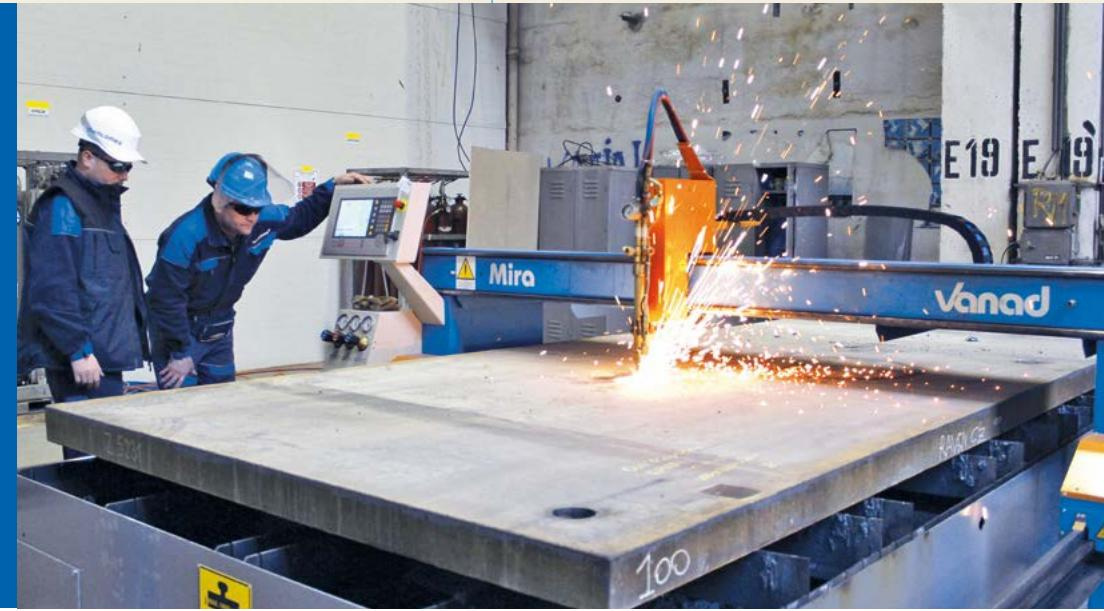
◀ CNC pálicí stroj Vanad MIRA je vybaven autogenní technologií, laserovým ukazovátkem a elektrickým zapalováním plamene autogenního hořáku. Snímek zachycuje propal 100 mm konstrukční oceli. CNC stroj MIRA je také nainstalován v našem předváděcím centru, kde si jej můžete prohlédnout a vyzkoušet.
